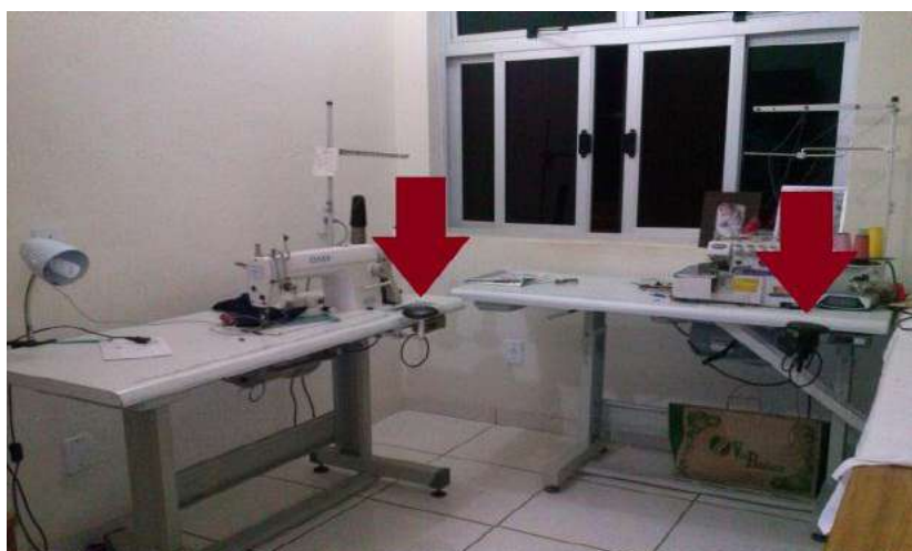
Figura 4: Maquinas de Costura da entrevistada, acelerador indicado por setas.
